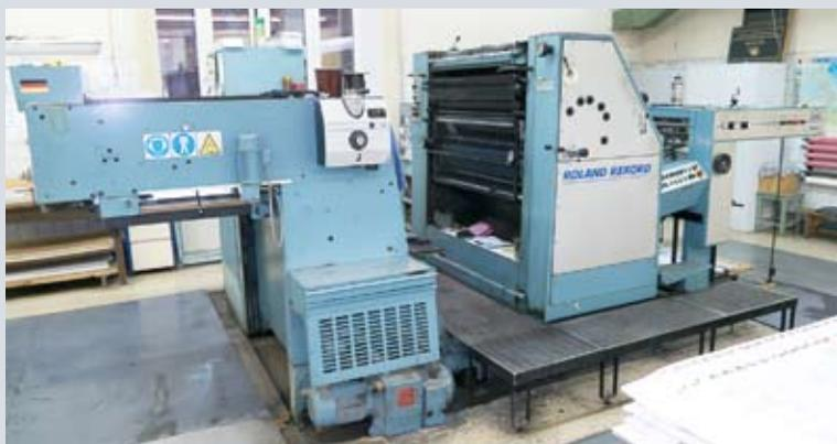
Печать геологических карт ведется на однокрасочных офсетных машинах компании manroland с использованием десятков красок и в шесть прогонов. Такой способ последовательного нанесения красок позволяет воспроизвести правильную раскраску геологических объектов
