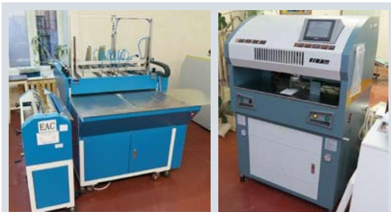
Оборудование для производства книг в твердом переплете: крышкоделательная машина и резальная машина для трехсторонней обрезки блока
