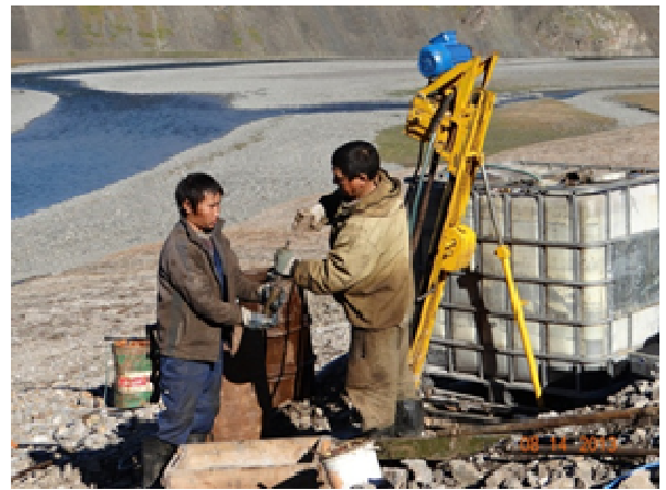
Рис. 9. Геофизики на профиле (слева), бурение скважин установкой УКБ 12-25 (справа)
