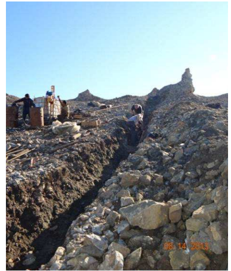
Рис. 8. Общий вид канав на участке «Кошка» (а), проходка канавы по рудной зоне (б)
