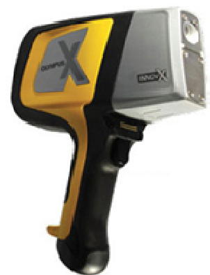
Рис. 10. Сфалеритовая (слева) и галенитовая (в центре) руда; портативный рентгено-флуоресцентный анализатор Дельта-50 (справа).
