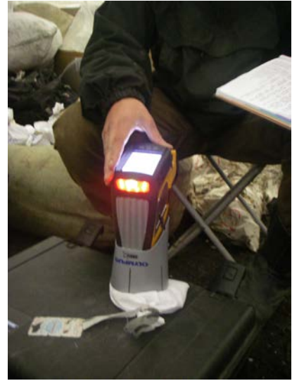
Рис. 7. Буровая установка УКБ 12/25 (а), замер содержаний элементов рентгенофлуоресцентным анализатором (б).
