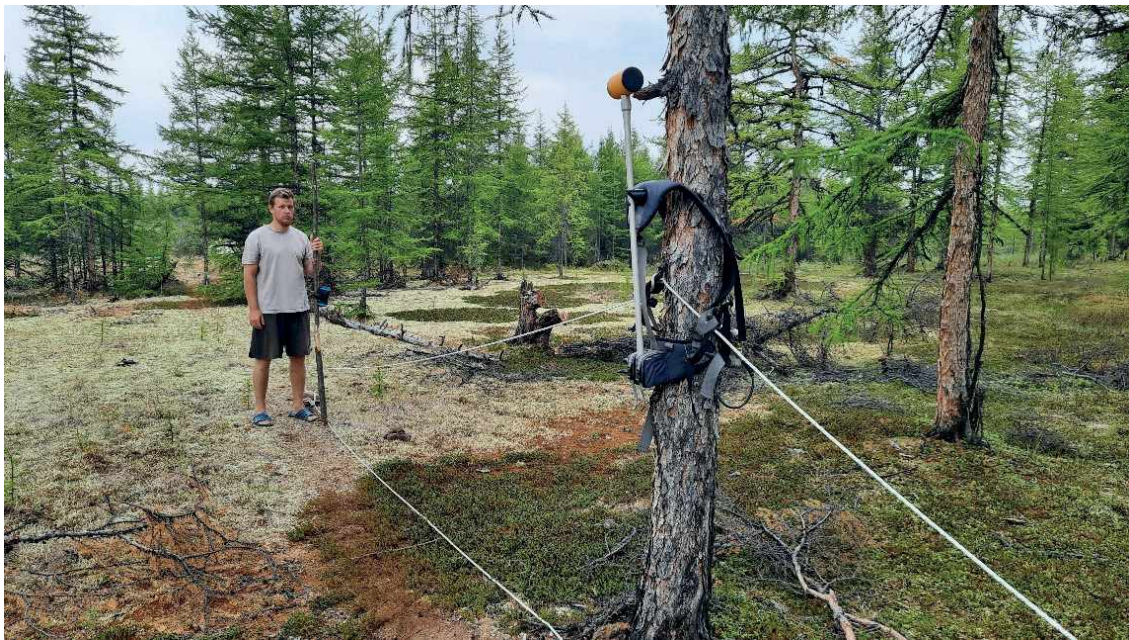
Рис. 3. Эксперимент с приближением навигационного приемника к магнитометру
