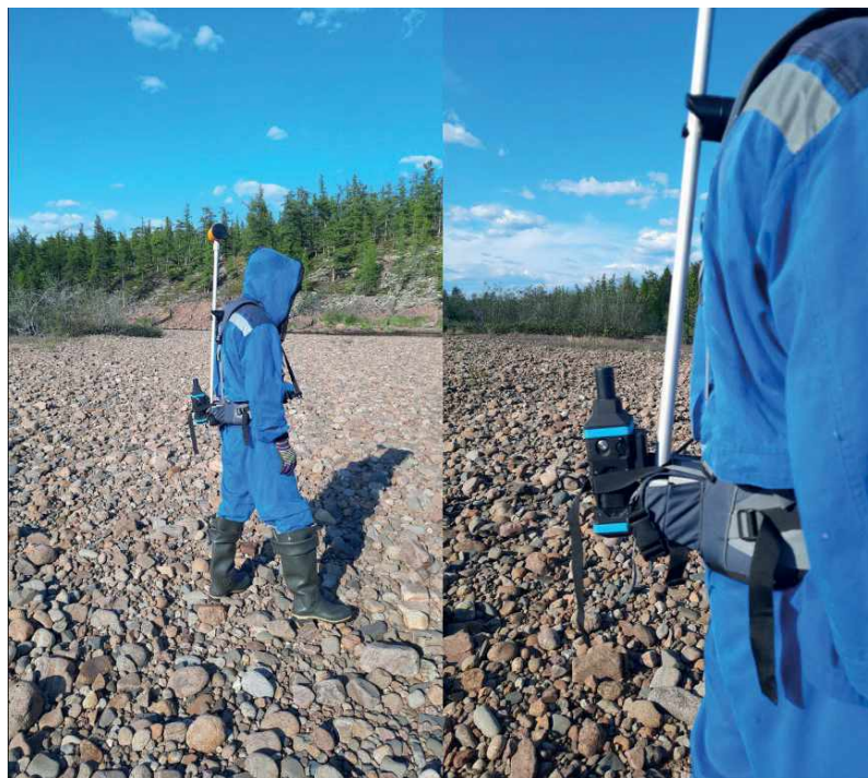
Рис. 1. Положение навигационного приемника Geobox ForaLux на поясе оператора в процессе съемки
