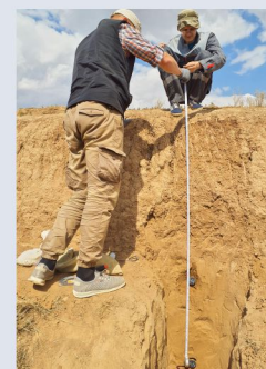
Отбор и документация проб ОСЛ в позднечетвертичных отложениях
