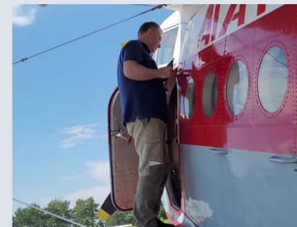
Гарасика А.И. монтирует петлю электроразведки
