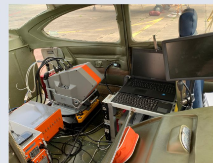
Гиперспектрометр внутри самолета Cessna 182
