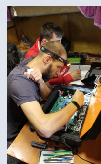
Ремонт сейсмостанции в полевых условиях
