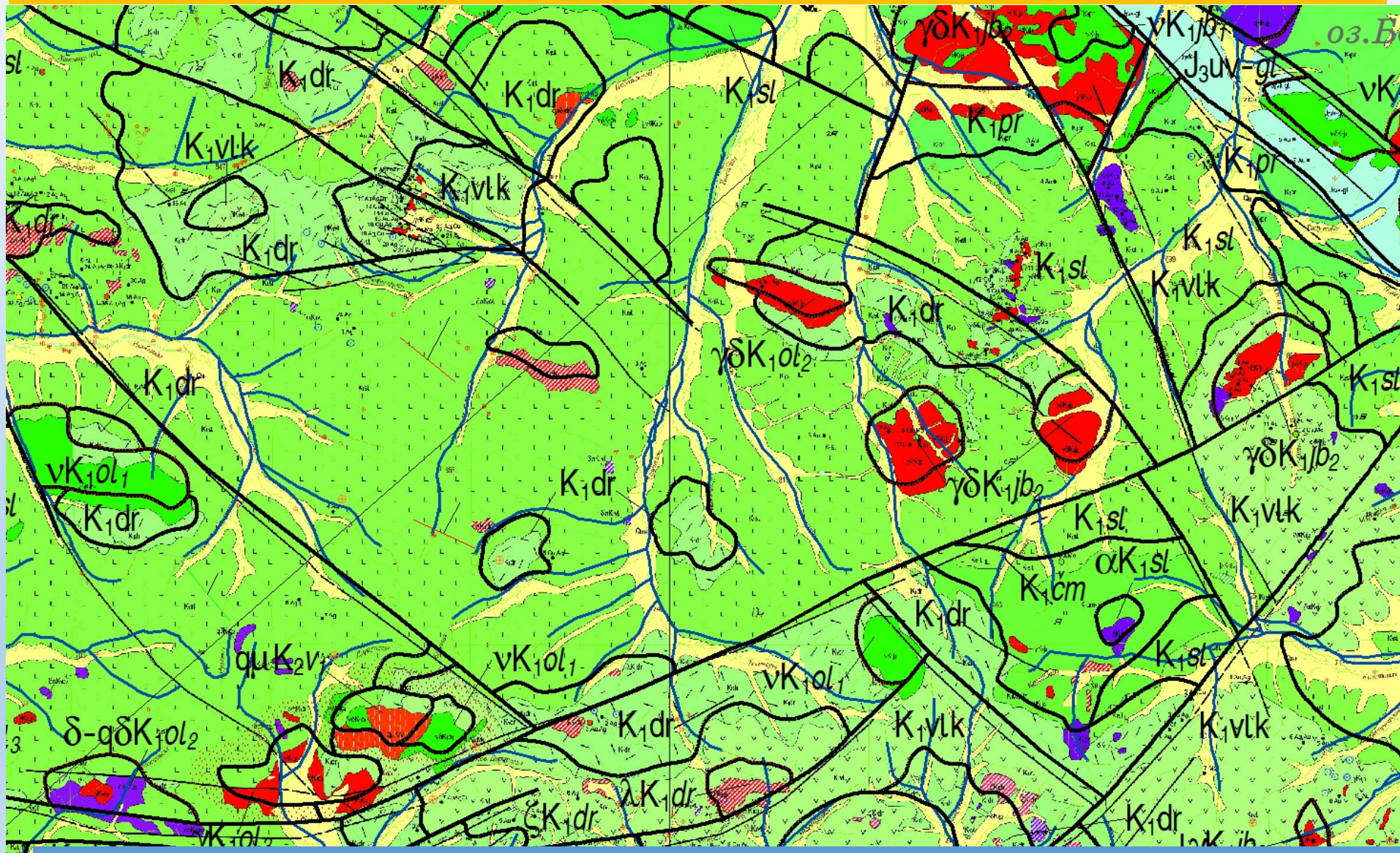
Чрезмерная генерализация при рисовке контуров, несовпадение метрики гидросети
