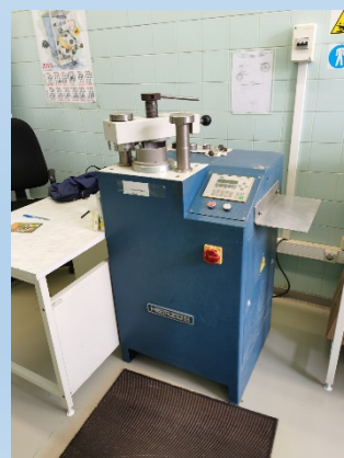
Пресс НР 40 ф. Herzog Усилие 20 тонн
