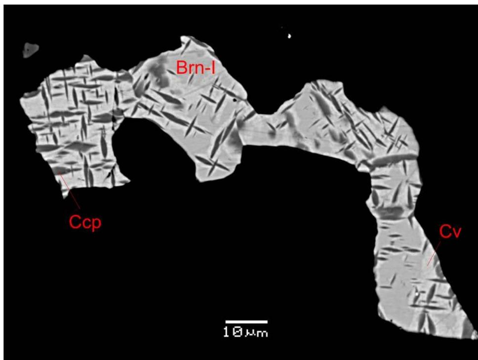
Рис. 1. Зерно борнита-I (Bm-I) с решетчатой структурой распада халькопирита-I (Ccp- I). Халькопирит-I замещается ковелином (Cv) . Фото в отраженных электронах.
