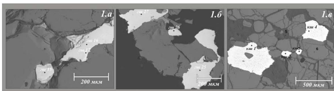
Рис. 1. Микрофотографии зёрен платиноидов в отражённых электронах с месторождений: Господская шахта – 1а, 1б, Катаевская штольня– 1в. Крестиками обозначены точки микрозондового анализа. Серые зёрна – хромшпинелид, чёрная масса – серпентин.
