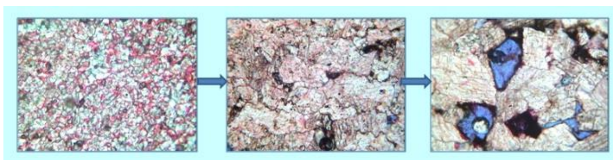
Рис. 1. Уменьшение содержания кальцита с увеличением размера зерен доломита.
