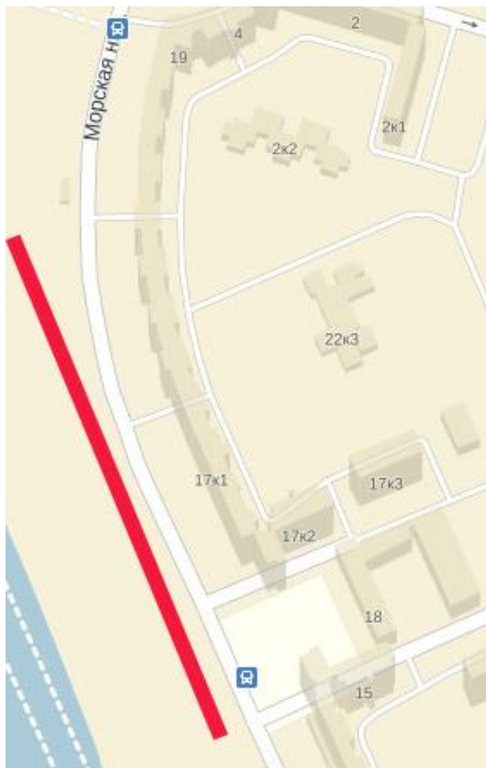
Рис. 1. Карта расположения линии профиля. Общая протяженность – 308 м. Пикетаж начинался с 200 м.
