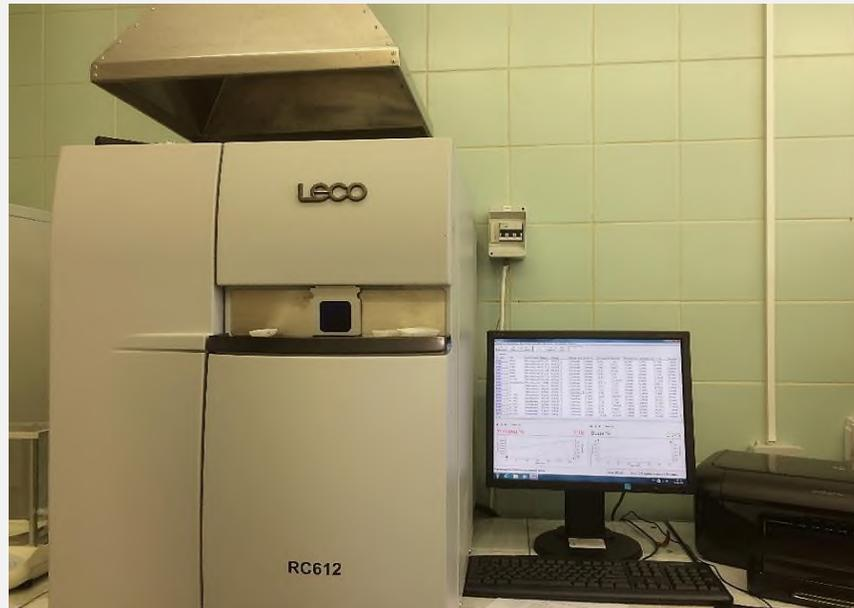
Широкий диапазон определения органического и неорганического углерода, влаги и кристаллической воды (от 100 ppm до 20%).
