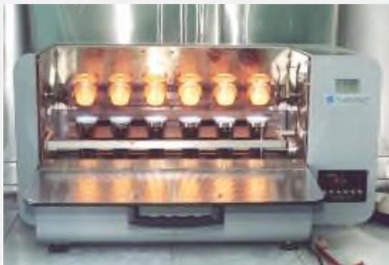
**Автоматическая плавильная установка**
