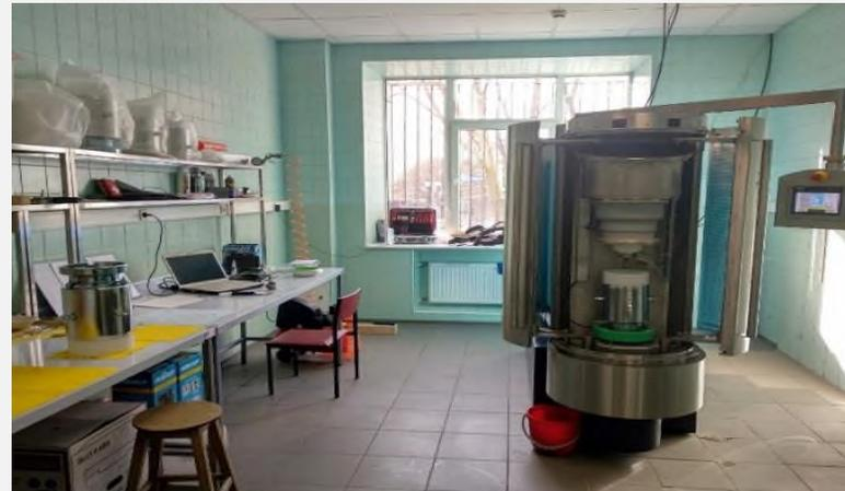
Установка высокоимпульсного электрического разряда
