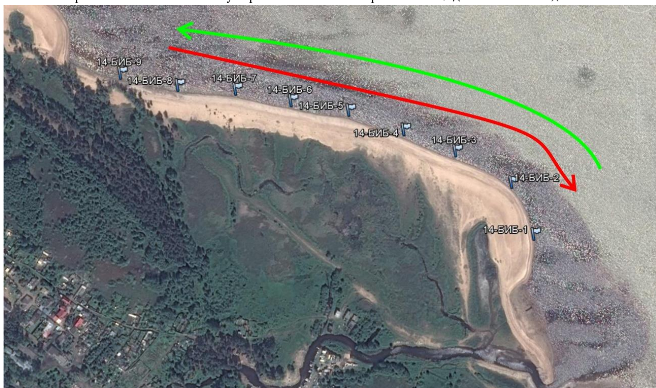
Рисунок 110. Схема направленности вдольберегового потока наносов: красная стрелка показывает восточный перенос материала с уровнем значимости 0,01; зеленая стрелка – западный перенос материала с уровнем значимости 0,05
