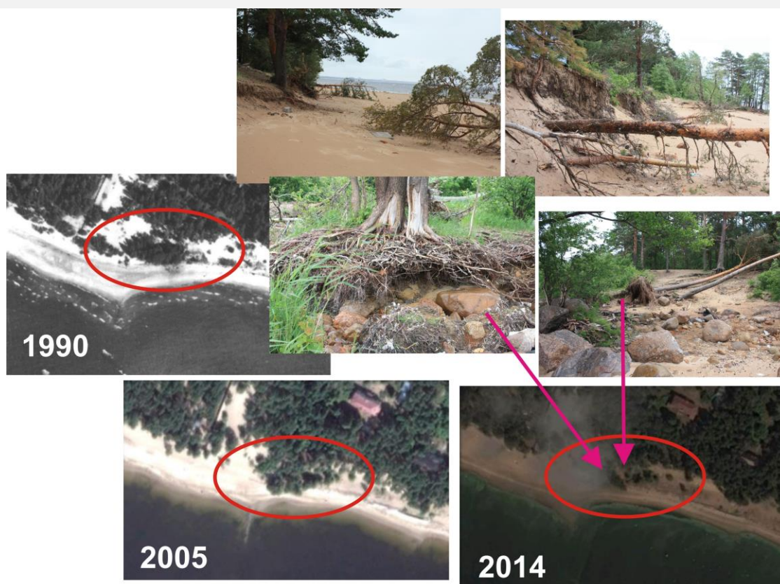
Рисунок 97. Участок интенсивного размыва берега штормами осени 2013 г. (пос. Репино). Станция наблюдения 14-КурБ-39
