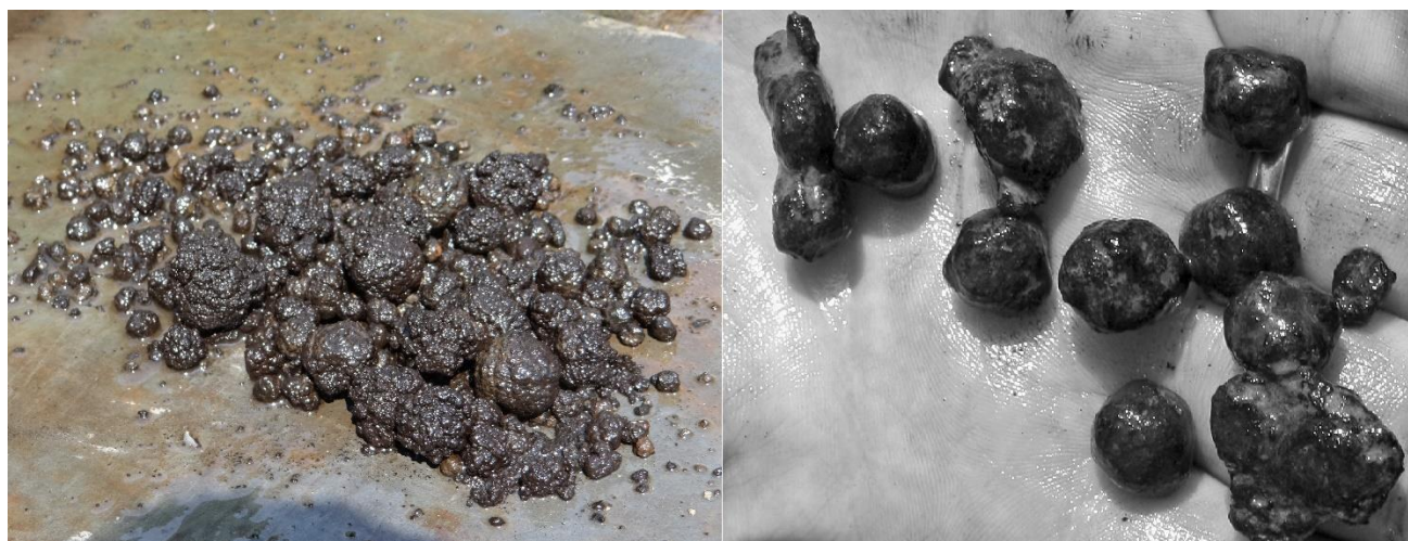
Рисунок 115. Сферические конкреции: слева – отобранные на ненарушенной площади (гранулярная текстура поверхности, размер ЖМК от первых миллиметров до 3 см), справа – отобранные в пределах площади добычи (сглаженная поверхность, отсутствие микроконкреций)
