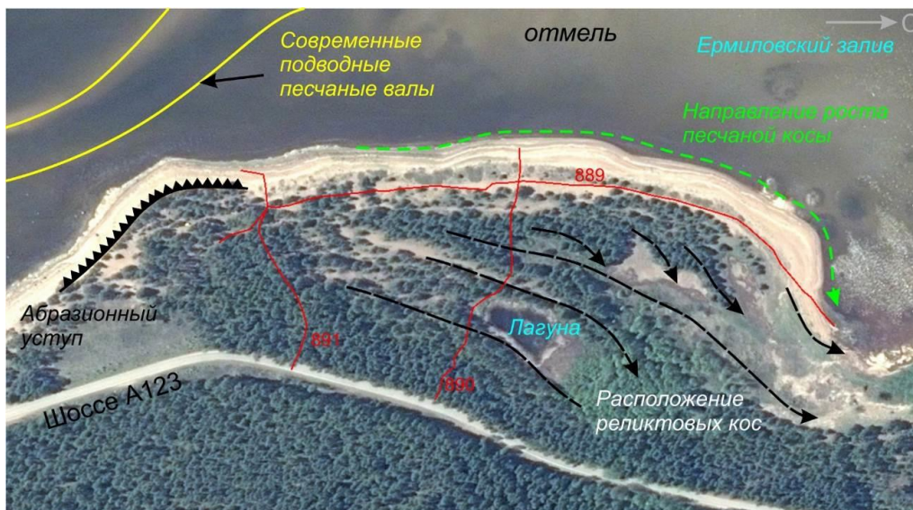
Рисунок 59. Схема роста аккумулятивной формы на восточном берегу Ермиловского залива. Красные линии – георадарные профили
