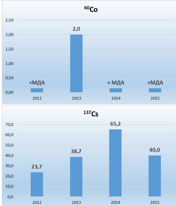
Рисунок 147. Изменение активности ^{137}\text{Cs} и ^{60}\text{Co} (Бк/кг) в донных осадках станций Д6-23 за 2012–2015 годы
