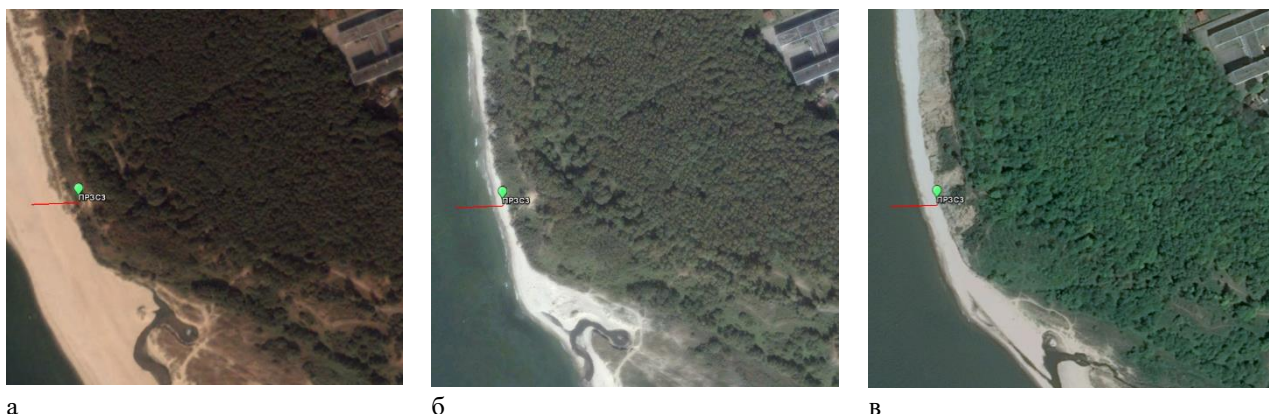
Рисунок 126. Активизация абразионного уступа м. Песчаный в результате сокращения пляжа: а – 2002 г., б – 2005 г., в – 2014 г.
