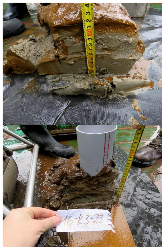
Рис. 12. Фотографии верхней части геологического разреза донных грунтов – глинистые илы: станции 16-K3-21 и 16-K3-23
