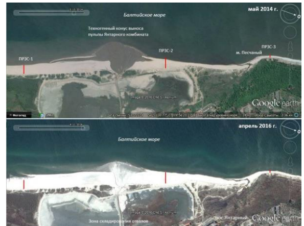
Рис. 119. Трансформация берегового контура с 2014 по 2016 г. в районе пос. Янтарный. Красными линиями показано положение нивелировочных профилей. Космоснимки Google Earth
