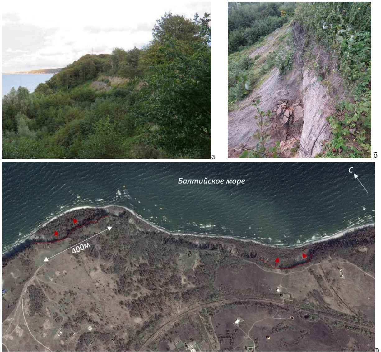
Рис. 96. Оползни к востоку от м. Таран: а – пример глубокого оползня; б – развитие вторичных склоновых процессов в верхней части берегового уступа; в – оконтуривание поверхностей скольжения оползней
