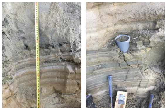
Рис. 97. Изучение инженерно-геологического разреза: а – измерение мощности слоев; б – отбор монолитов грунта для измерения физико-механических свойств
