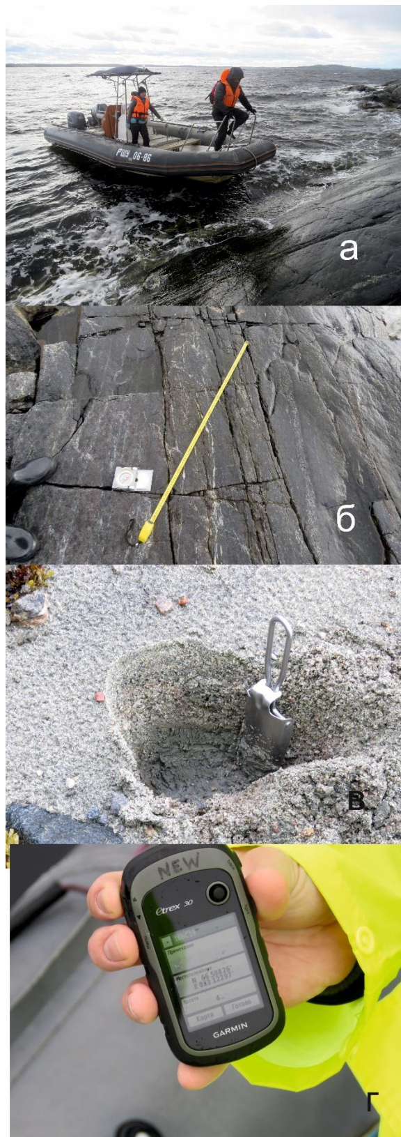
Рис. 30. Рабочие моменты береговых маршрутов в проливе Великая Салма: а – использование моторной лодки в ходе работ; б – измерение параметров трещиноватости; в – отбор пробы отложений пляжа, г – GPS фиксация точек наблюдения
