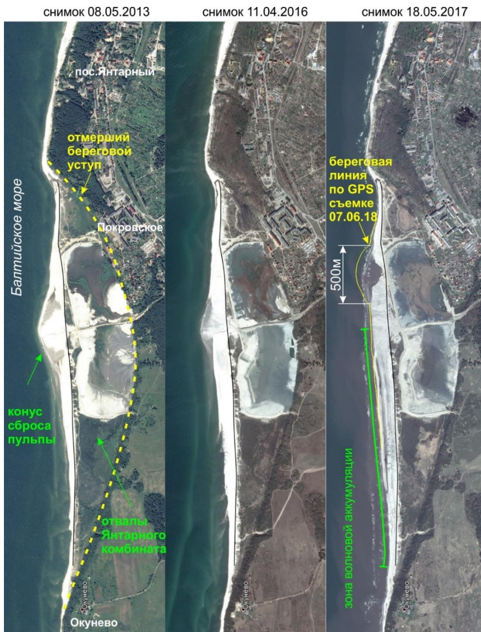
Рисунок 85. Динамика трансформации берегового контура в районе пос. Янтарный по данным анализа космоснимков Google Earth
