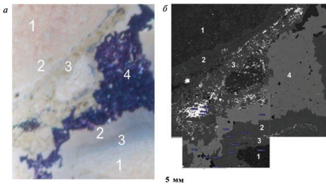
**Рис. 3.** Участок для проведения микроанализов (*а* – изображение в проходящем свете, *б* – обратно рассеянные электроны (ОРЭ))
