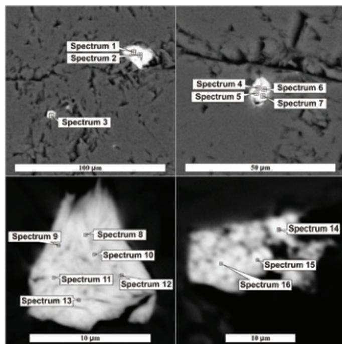
Рис. 13. Минеральные формы молибдатов уранила в массивном флюорите
