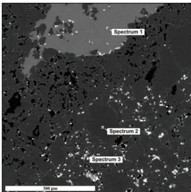
Рис. 15. Микрофотография распределения рудного вещества в доломите
