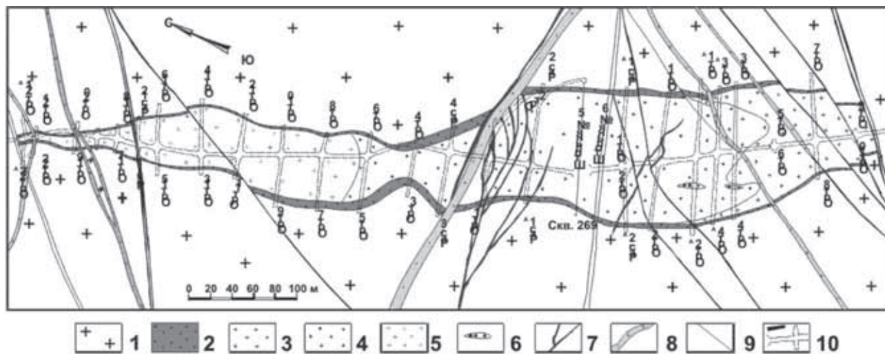
Рис. 6. Схематический геологический план Березитового месторождения. Строение метасоматической зоны № 1 на горизонте 676 м (по материалам геологической службы ПГО «Дальгеология»)
