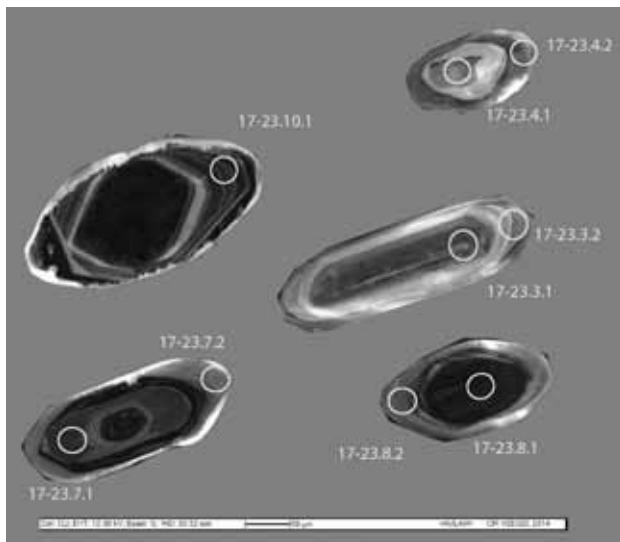
Рис. 5. Катодолуминесцентное изображение типичных цирконов из мигматитов биотит-амфиболовых полосчатых (пр. 17/23) с точками измерений
