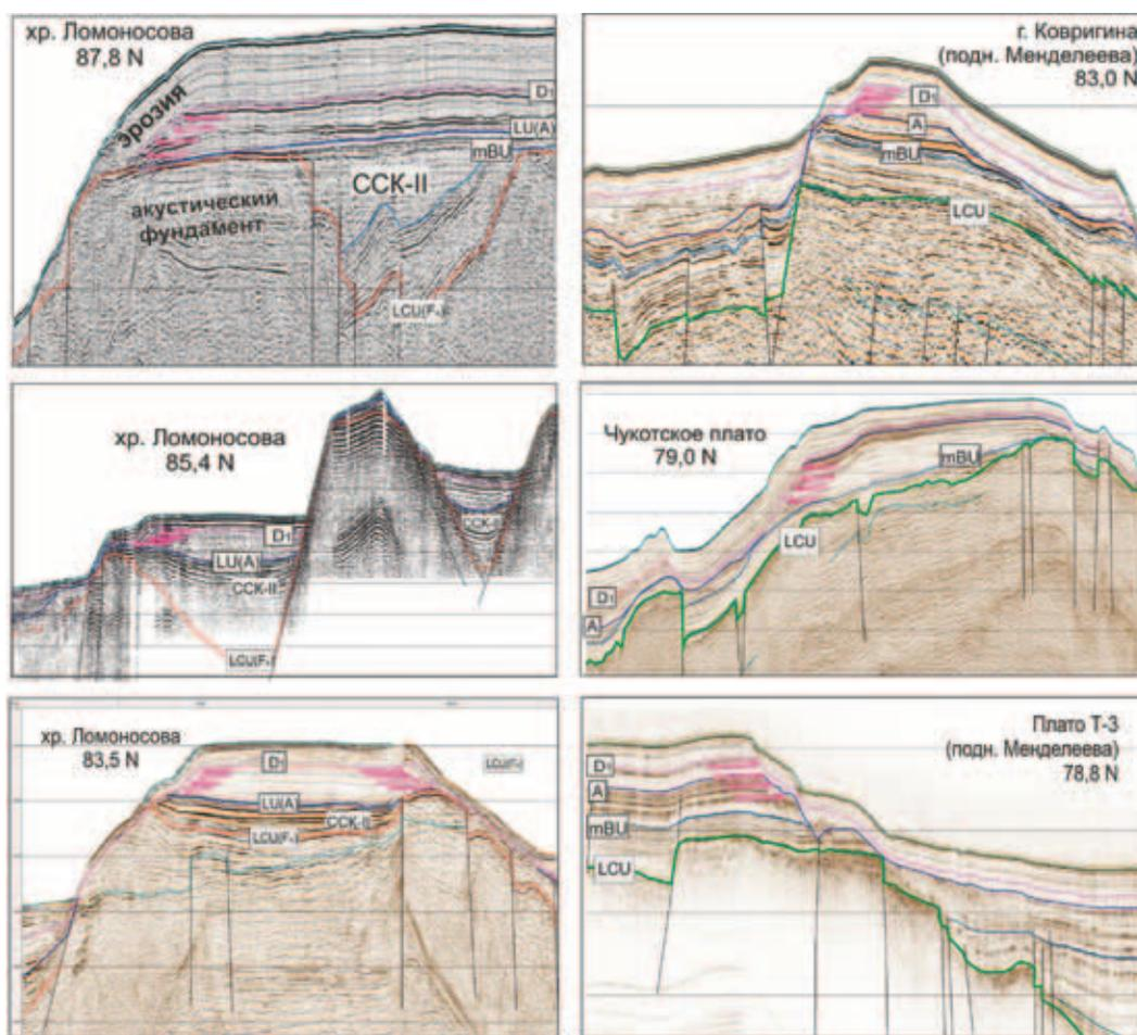
Рис. 4. Фрагменты сейсмических профилей через вершины основных поднятий СЛО. Стрелками обозначены области размыва отложений под отражающим горизонтом D<sub>1</sub>
